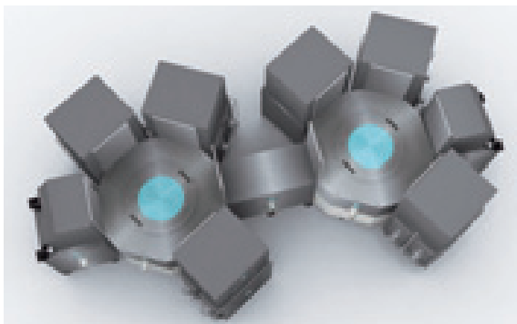
(イメージ) 縦型蒸着装置コンセプト
